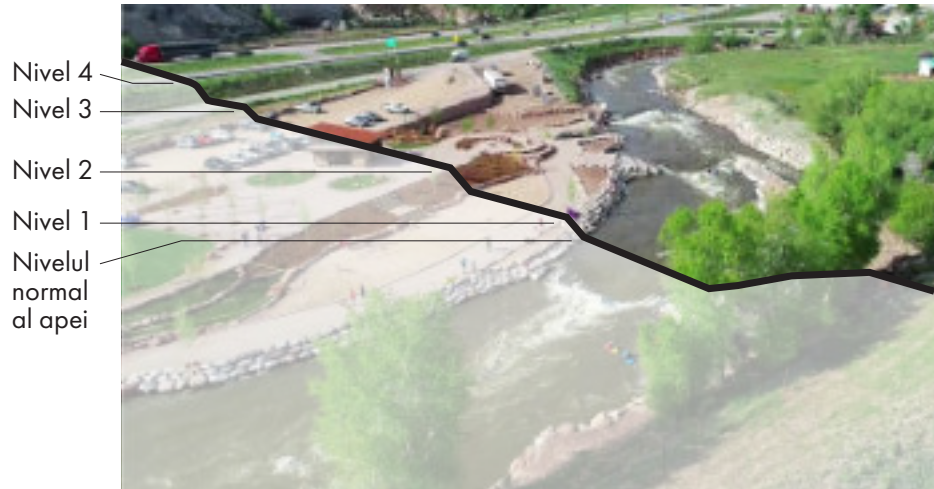
Exemplu de amenajare pe niveluri, Colorado, SUA, ing. Scott Shipley. Nivelul 1 este inundat o dată la 10 ani, nivelul 2 o dată la 100 de ani, nivelul 3 la 200 de ani, nivelul 4 peste 200 de ani.
