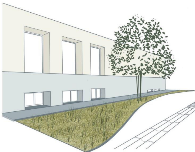
Fig. 31. Goluri (ferestre) la nivelul terenului prin care apa poate pătrunde în clădire.
