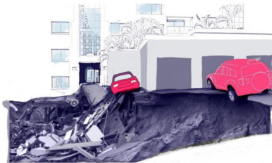
Fig. 4. Dislocarea terenului de sub sistemul de fundare al clădirilor.
